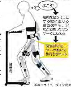
「ロボットスーツ HAL」の主な仕組み
